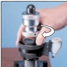
Fassen Sie den **multicut\*** am Grundkörper und am Druckstück. Schrauben Sie ihn in die Einschraubbohrung.
