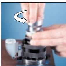
Drehen Sie den Spannring nach links (entgegen dem Uhrzeigersinn), bis Sie den Anschlag spüren, und geben Sie somit die axiale Beweglichkeit des Spannbolzens frei.
