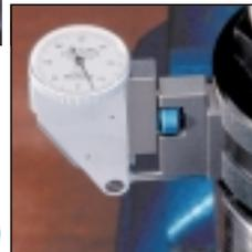
Fassen Sie den **multicut\*** am Grundkörper und drehen Sie ihn nach rechts (im Uhrzeigersinn), bis Sie einen weiteren Umkehrpunkt des Zeigers der Fühlhebelmessuhr feststellen können. Der angezeigte Wert ist die Lageabweichung (Winkellage) der Dichtfläche zur Mittelachse der Einschraubbohrung.
