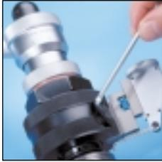
Legen Sie den Messadapter mit der Fühlhebelmessuhr in die Aufnahmenut des **multicut\*** und klemmen Sie diesen durch Drehen der beiden Gewindestifte mit einem geeigneten Innensechskantschlüssel fest.
