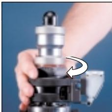
Fassen Sie den **multicut\*** am Grundkörper und drehen Sie ihn nach rechts (im Uhrzeigersinn), bis Sie einen Umkehrpunkt des Zeigers der Fühlhebelmessuhr feststellen können.
