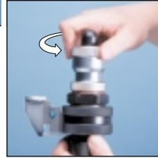
Fassen Sie den **multicut\*** mit der einen Hand am Einschraubgewinde und drehen Sie den Spannring mit der anderen Hand nach links (entgegen dem Uhrzeigersinn), bis Sie den Anschlag spüren. Wenden Sie hierbei keine Gewalt an!
